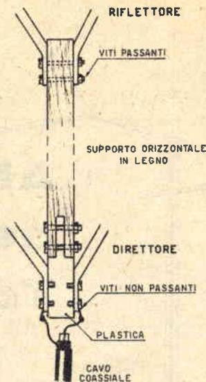
to di plastica mediante viti non passanti; il supporto di plastica, a sua volta, risulta fissato ad intaglio, mediante viti passanti al sostegno di legno.
